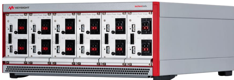
用于测试多达 12 个电池单体原型的桌面系统
