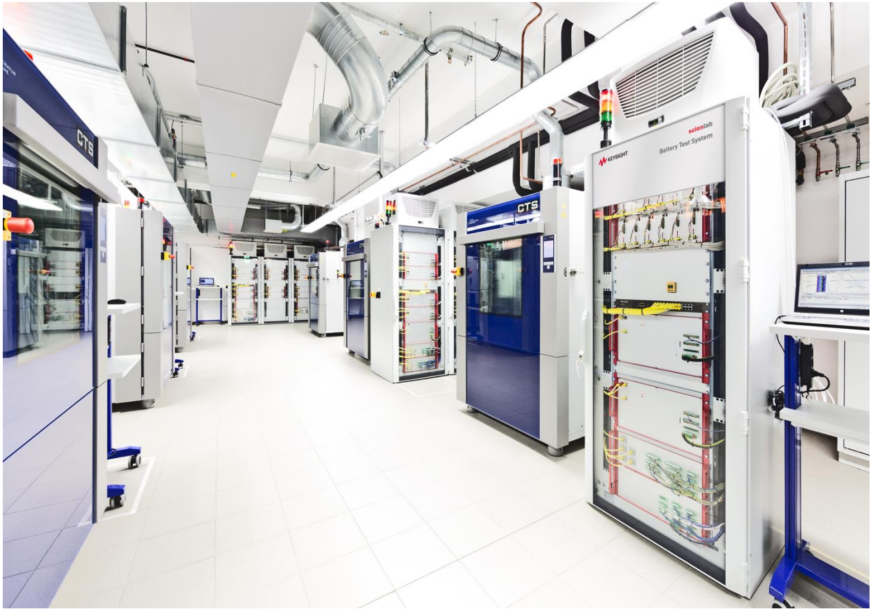
测试台架，用于表征和开发电池单体和模块
