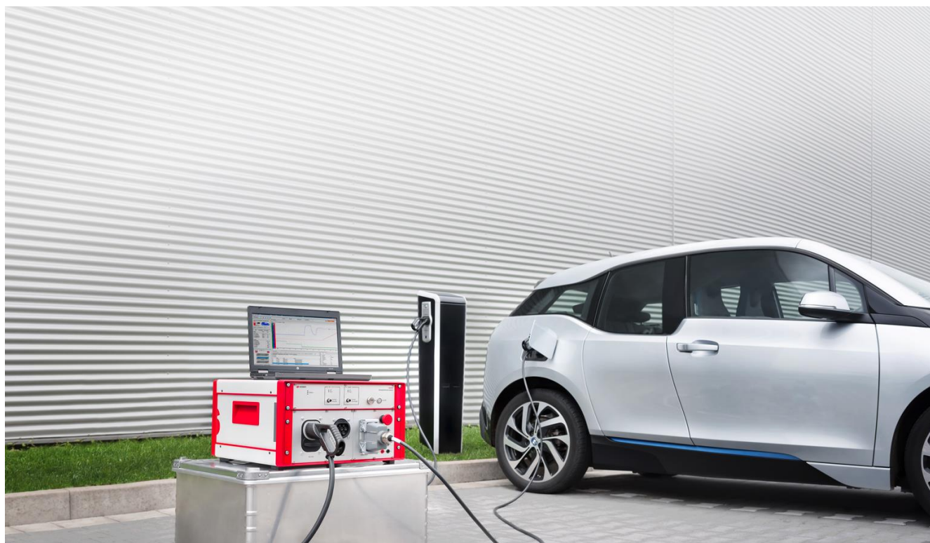
在现场用作中间人系统的 Charging Discovery System
