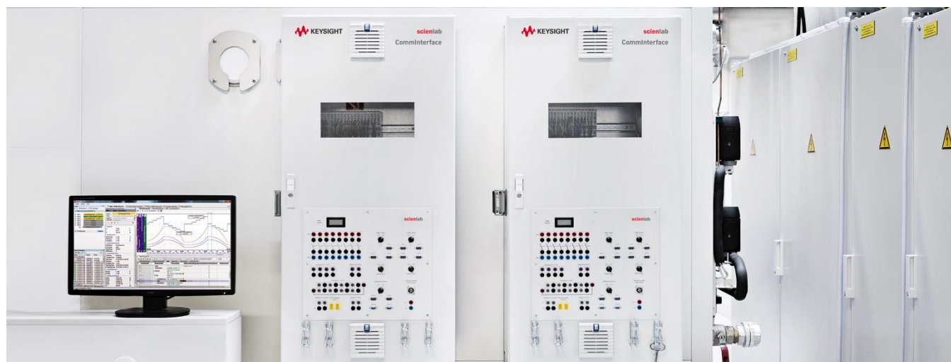
测试台架控制系统配备连接被测器件的通信接口 (CommInterface)
